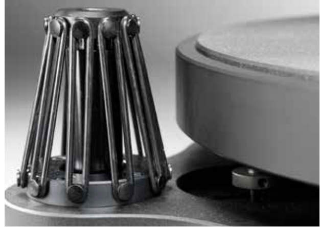
Das Subchassis ist an drei Domen mit jeweils zehn Gummiringen aufgehängt. Diese halten locker ein Jahrzehnt durch und sind anschließend einfach ersetzbar.
